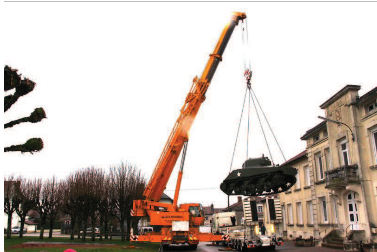
■ Une grue impressionnante de 250 tonnes a installé le char sur l'emplacement réservé.
